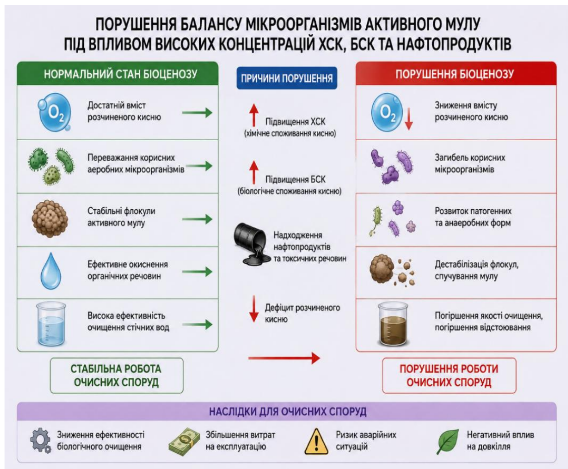
Рис. 2.1. Механізм пригнічення автохтонного бактеріопланктону та консервації умовно-патогенних штамів під дією хімічного стресу.
