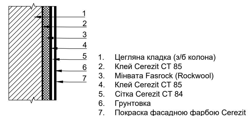
Деталь "А" утеплення зовнішніх стін
