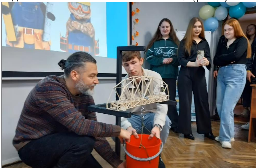
Рисунок 4 – Випробування моделі моста на міцність [2].
