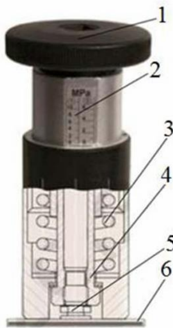
Рисунок 2.1 – Пристрій для визначення адгезійної міцності лакофарбового покриття. 1 - поворотна ручка; 2 - вимірювальна шкала; 3 - пружина; 4 - захват; 5 - випробувальний циліндр; 6 – випробовуване покриття.
