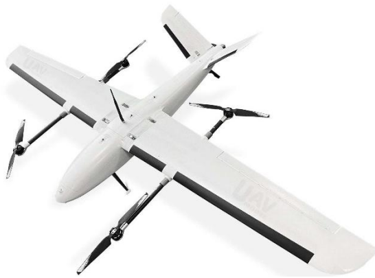
Рисунок 1.3 - Гібридні БПЛА (VTOL з фіксованим крилом):
