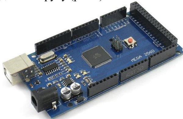
Рис.1. Мікроконтролер Arduino Mega 2560
