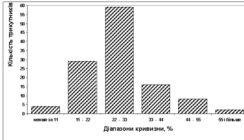
Рис. 5. Розподіл трикутників тріангуляції за діапазонами кривизни
