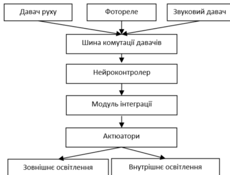
Рис. 1. Структура системи освітлення інтелектуального будинку
