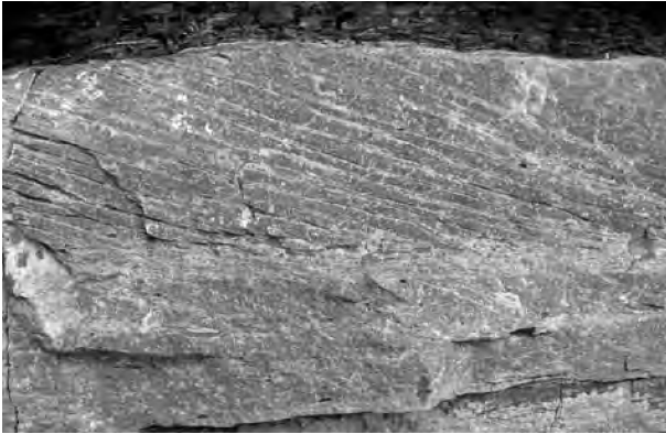
Світлина 3. Скисна верстуватість в девонських пісковиках
