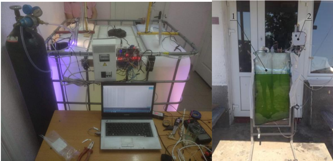
Рис.1. Система фотореактора для вирощування Chlorella vulgaris : а) на базі штучного освітлення; б) вертикального плоского типу
