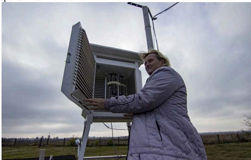
Рис. 2. Психрометрична будка АМСЦ Рівне (розташовані в ній сухий (ртутний) і вологий (спиртовий) термометри та гігрометр) [1]
