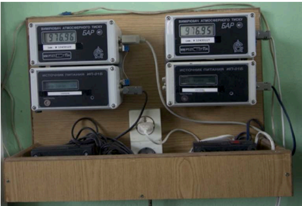
Рис. 5. БАР прилад для вимірювання атмосферного тиску на АМСЦ Рівне [1]
