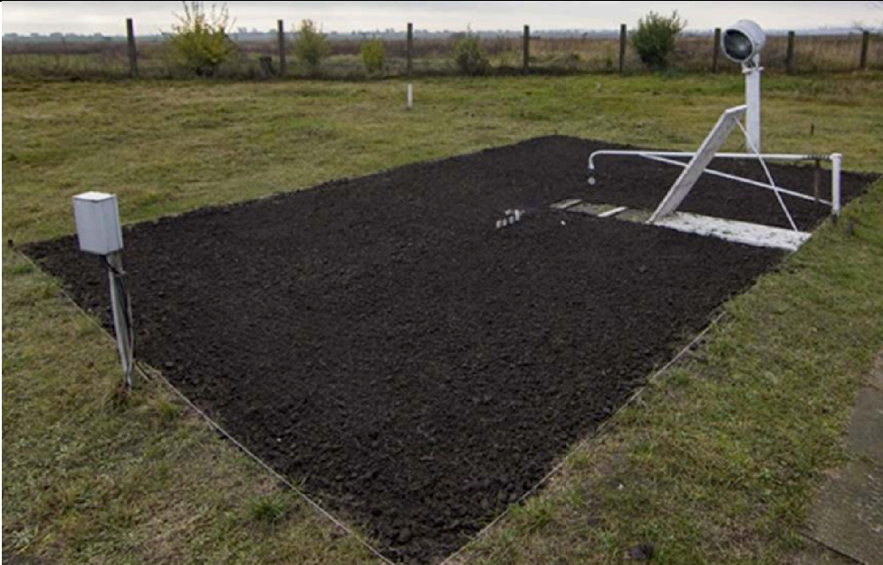
Рис. 4. Ділянка для вимірювання температури ґрунту на глибині 5,10,15 і 20 см. на АМСЦ Рівне [1]
