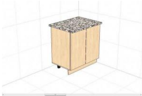
Рис. 1.30. Створення деталі «Стільниці»
