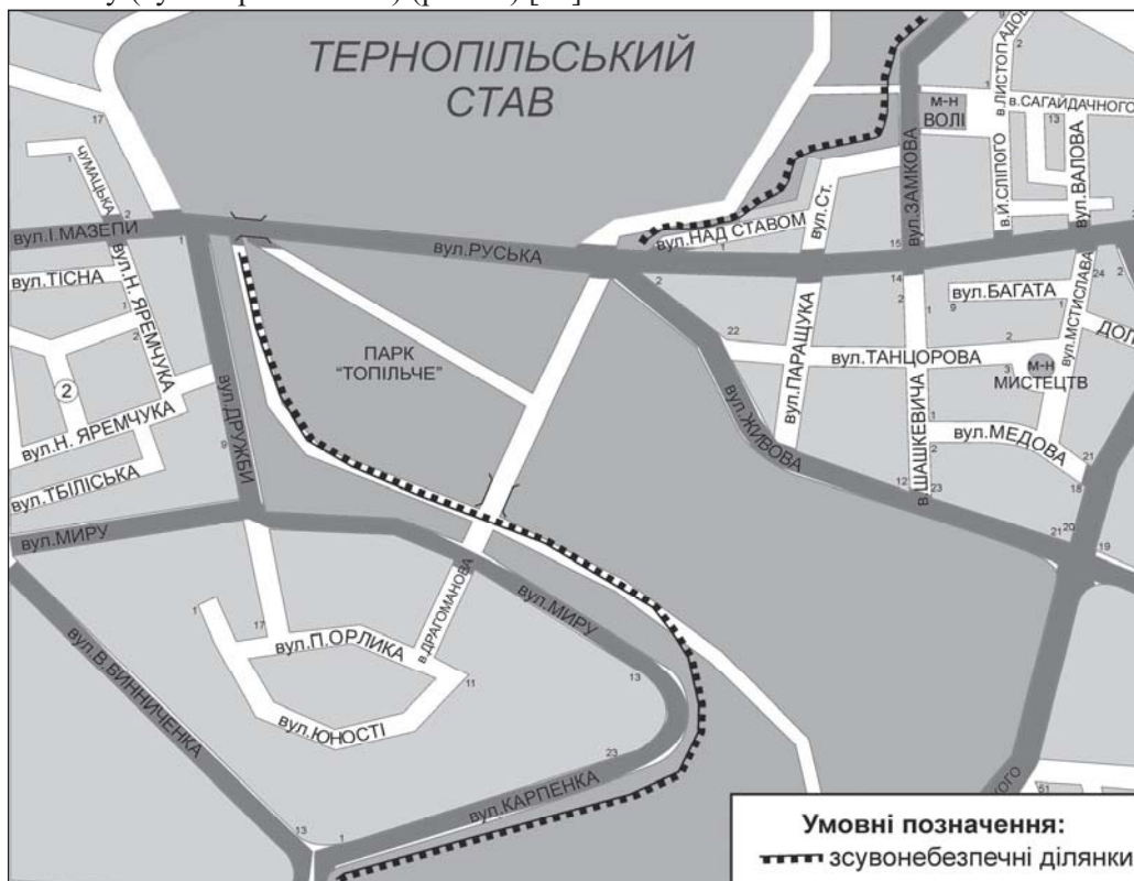
Рис. 6. Схема зсувонебезпечних ділянок в м. Тернополі [20]
