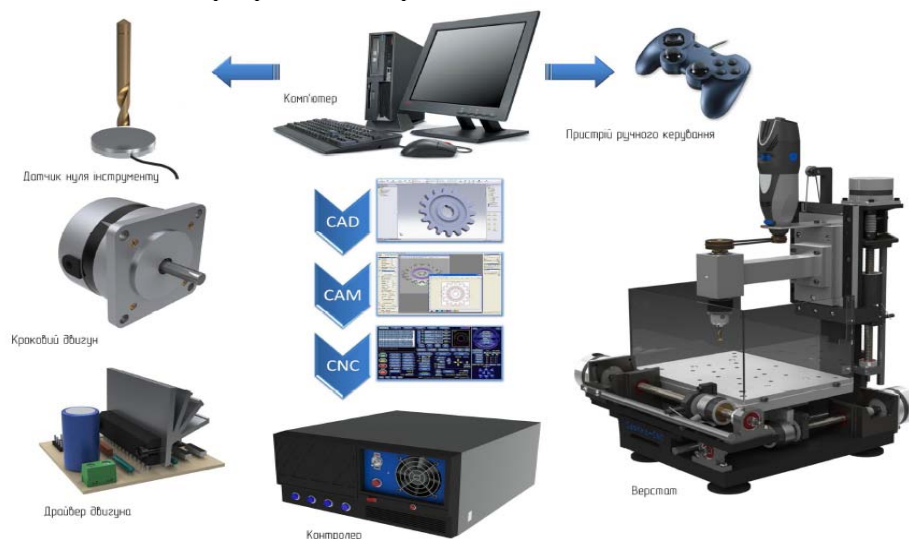
Рис. 1.1. Етапи підготовки процесу обробки деталі на верстаті з ЧПУ
