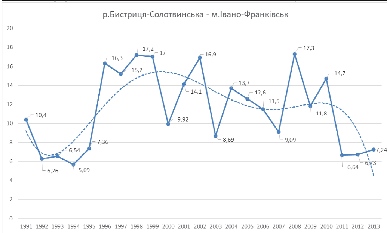
Рис. 4. Багаторічна динаміка середньорічних витрат води у річці Бистриця-Солотвинська (м. Івано-Франківськ) та її апроксимація поліномом 5-го ступеня.
