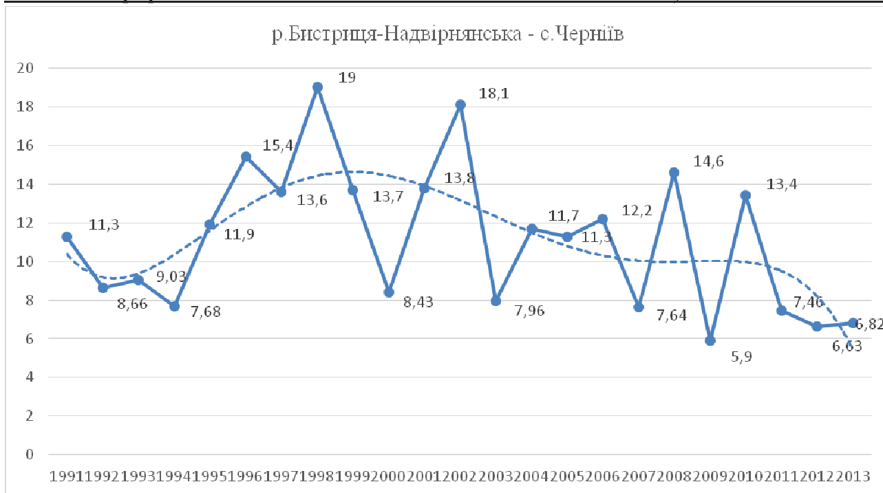
Рис. 6. Багаторічна динаміка середньорічних витрат води у річці Бистриця-Надвірнянська (с. Чернів) та її апроксимація поліномом 5-го ступеня
