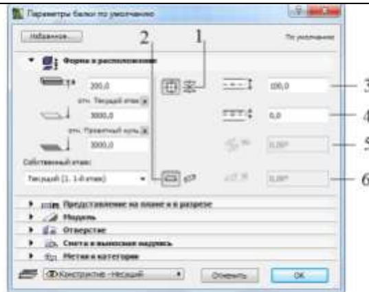
Рис. 10. Налаштування геометрії балки
