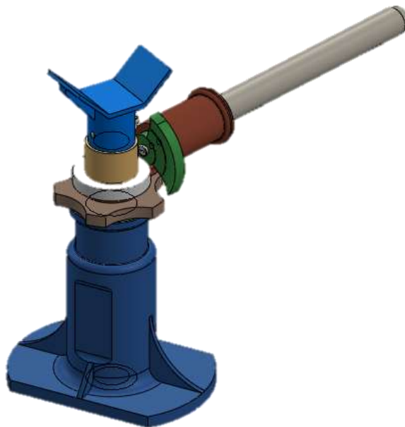
Рис. 4. Просторова геометрична модель гвинтового телескопічного домкрата.
