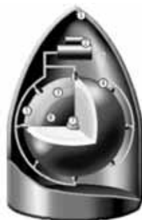
Рис. 1. 2D-зображення схеми ядерної боєголовки (1 — корпус; 2 — вибуховий механізм; 3 — вибухова речовина; 4 — електродетонатор; 5 — нейтронний відбивач; 6 — ядерне палне ( ^{235}\text{U} ); 7 — джерело нейтронів; 8 — процес стискування ядерного пального направленим всередину вибухом)
